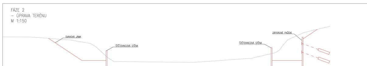
Obrázek 210 - Fáze 2 - Úprava terénu a zajištění stavební jámy
