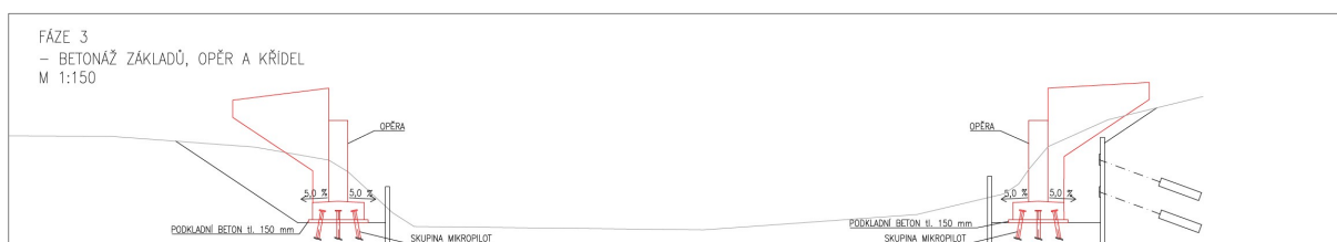
Obrázek 211 - Fáze 3 - Založení a betonáž opěr a křídel
