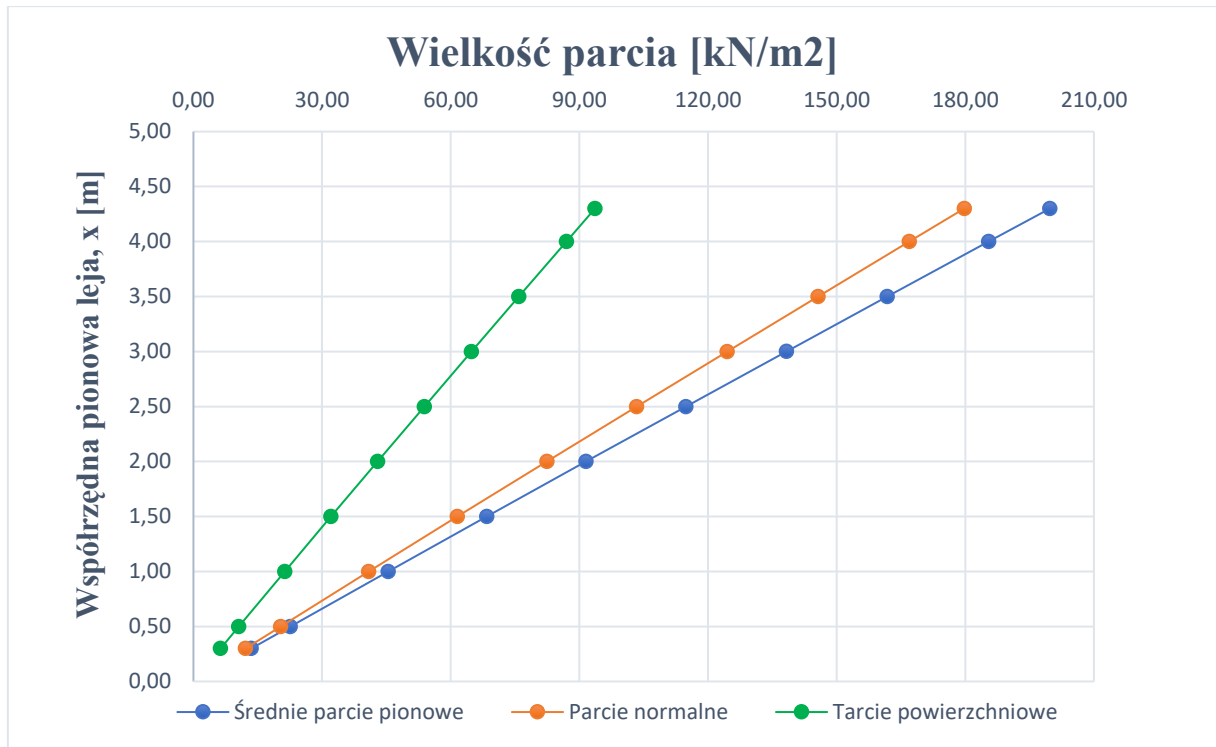
Rys. 4.3. Wykres parcia klinkieru cementowego na ściany lejki przy napełnianiu
