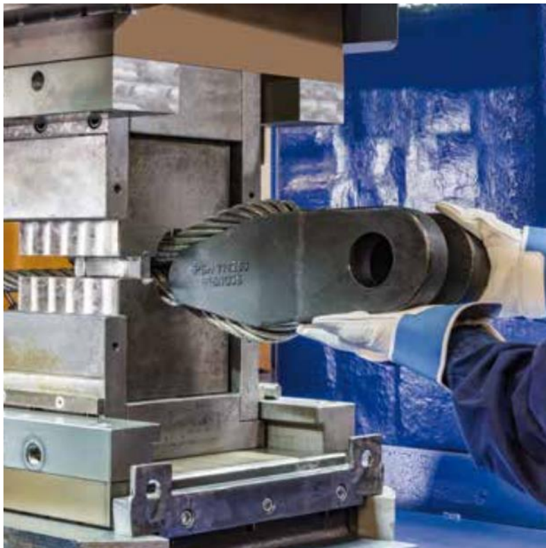
Rysunek 30 Przykład metody kucia na zimno [Źródło: Materiały firmy Pfeifer]
