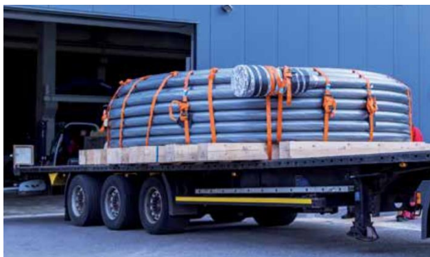
Rysunek 19 Przykład sposobu transportu cięgna ze splotu
