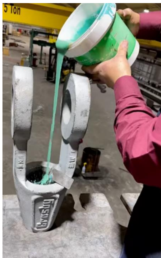
Rysunek 28 Zalewanie tulei kompozytem na bazie żywicy epoksydowej
