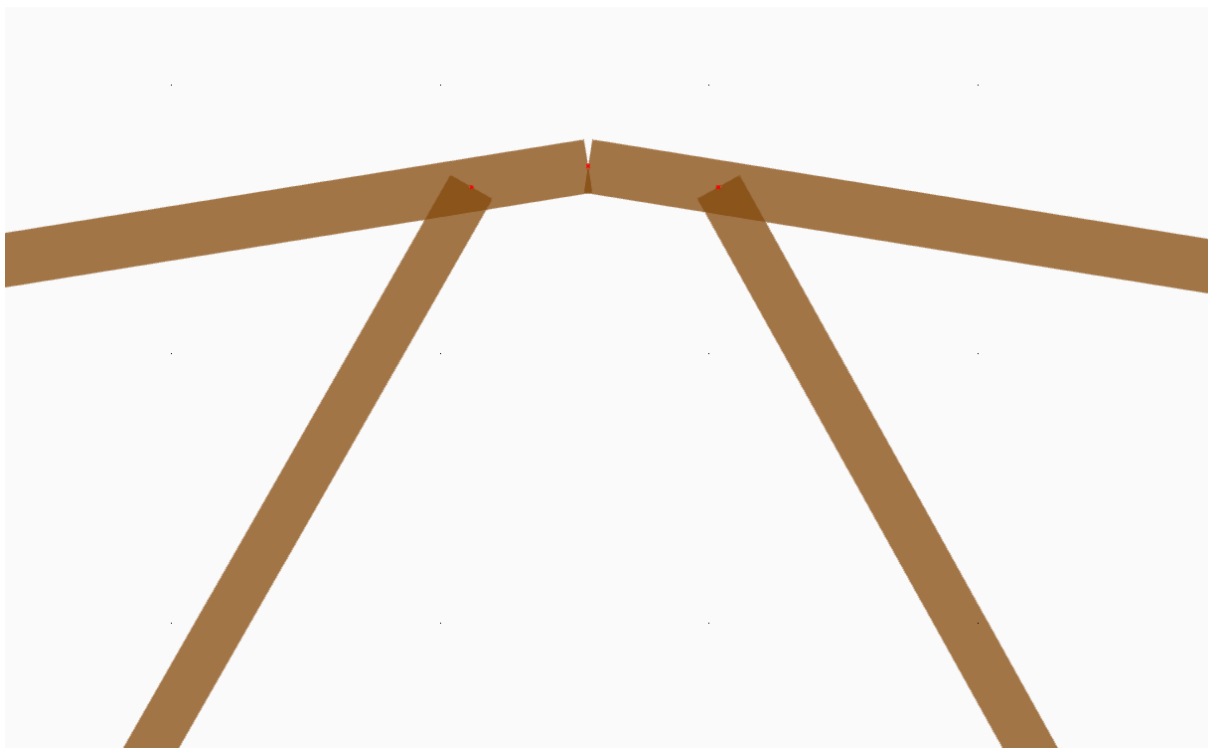
Rys. 5.62. Schemat obliczeniowy połączenia kalenicowego - RFEM 6. Źródło: opracowanie własne
