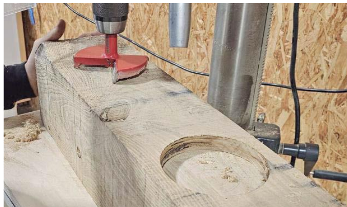
Imagen 05: Mecanizado de entalladura circular en taller.
