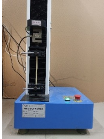
图 2-6 竹皮轴压箱形截面柱整体稳定试验装置
