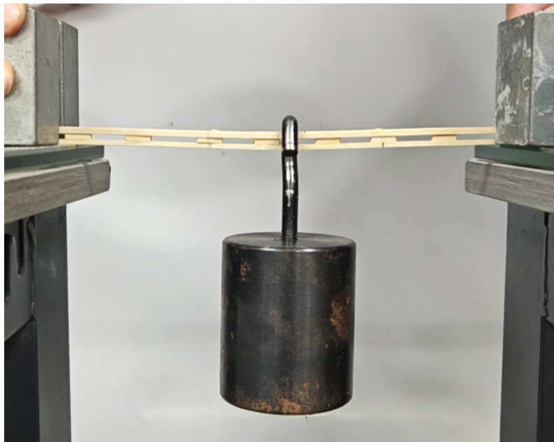
图 2-3 三点弯曲试验装置示意图
